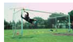
Art. HJT Head Jump Tester - strumento polivalente di misurazione ed allenamento, permette la valutazione delle qualità muscolari degli arti inferiori, dell'elevazione dei giocatori, del loro modo di colpire la palla di testa e dell'ampiezza del tuffo del portiere Instrument that allows the training and measurement of jump ability of players and goalkeepers
